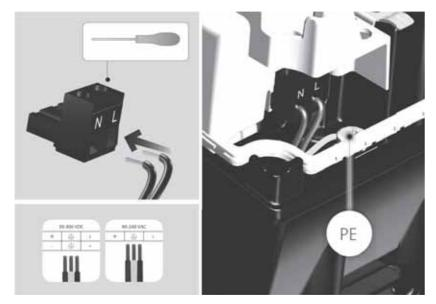
Fig. 3 Wiring diagram
